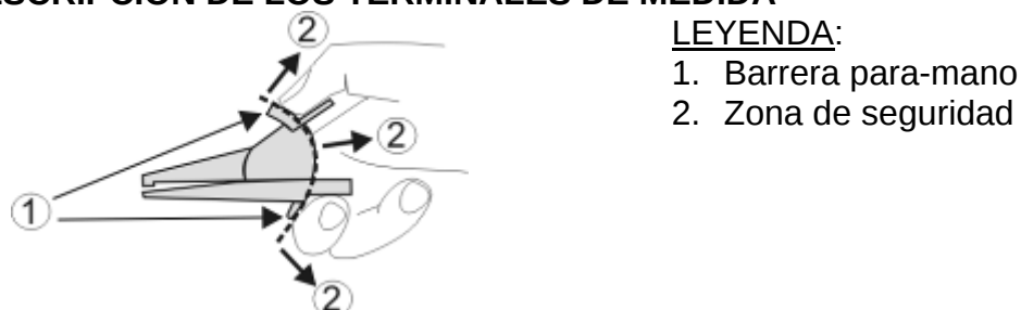
Fig. 4: Descripción de los terminales de medida
