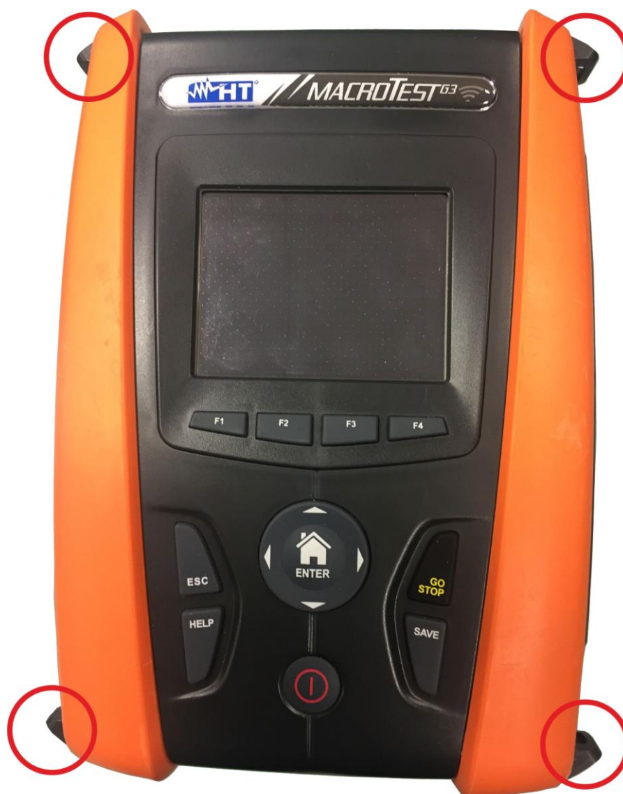
Fig. 48: Instrumento con protector de gomas y ganchos montados
