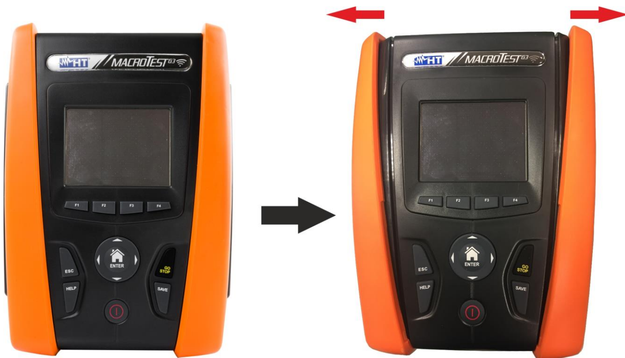
Fig. 46: Desmontaje protector de gomas laterales
