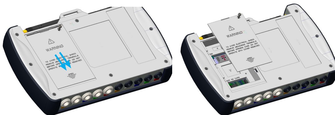
Figura 2: Extracción de cubierta de la batería.
