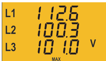
Figura 12: Pantalla de datos instantáneos visualizando los valores máximos.
