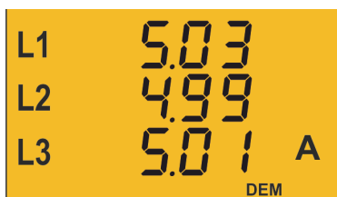
Figura 14: Pantalla de datos instantáneos visualizando el valor de máxima demanda.
