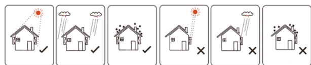
Fig. 7. Ubicaciones recomendadas para el inversor y las baterías.
