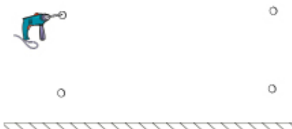
Fig. 15. Realización de los taladros.
