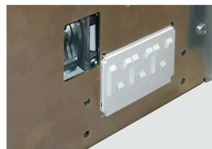
La plaque montée sous le DMX-SP actionne les contacts lors des opérations d'embrochage et de débrochage
