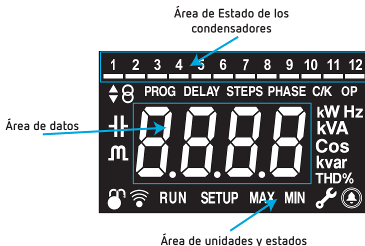
Figura 6: Áreas del display del computer C Wi-Fi.
