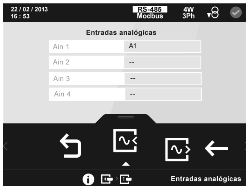
Figura 230: Pantalla de información de las entradas analógicas (Módulo Entradas/Salidas Analógicas).
