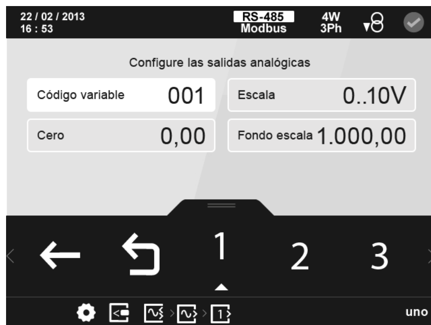
Figura 363: Pantalla de configuración de las salidas analógicas.
