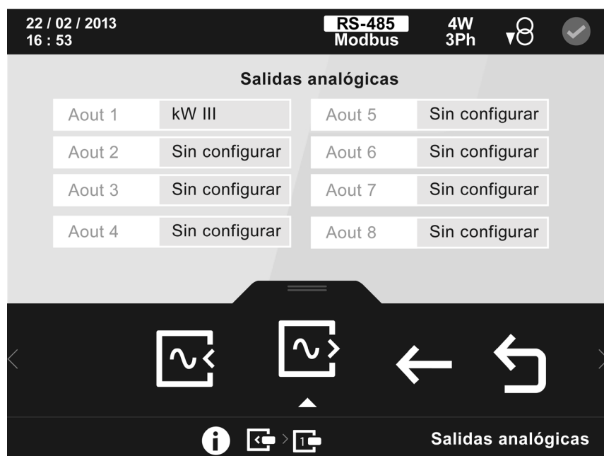
Figura 232: Pantalla de información de las salidas analógicas (Módulo Entradas/Salidas Analógicas)
