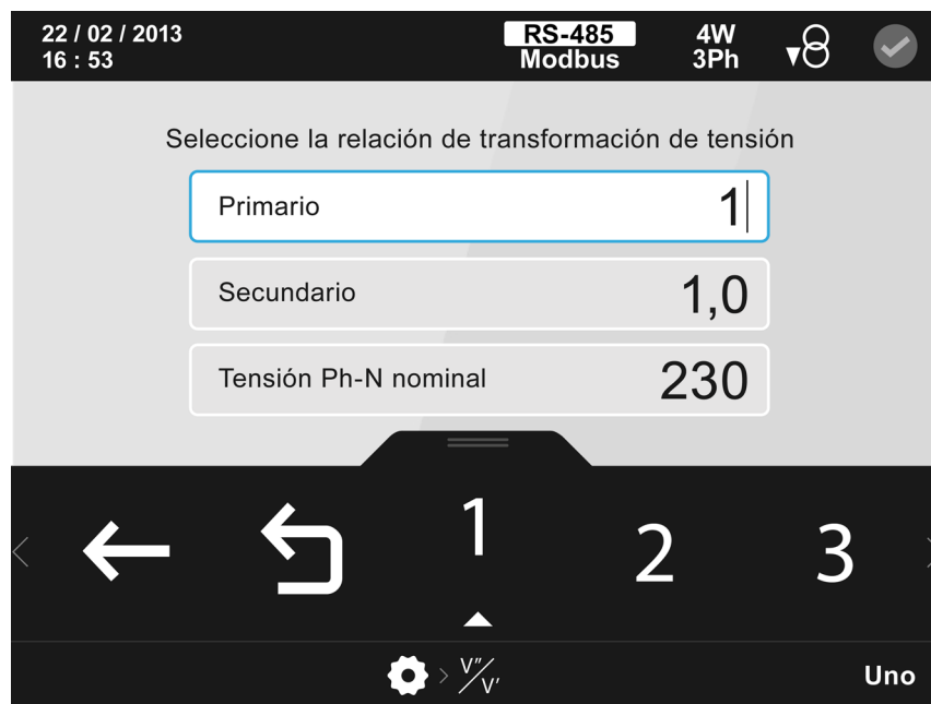
Figura 265: Pantalla de configuración de la relación de los transformadores de tensión.
