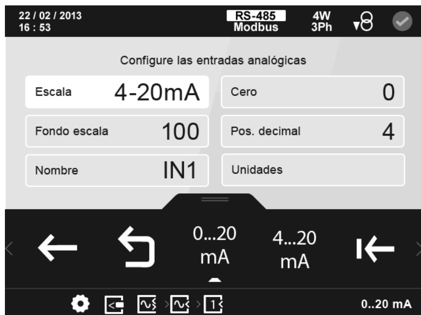
Figura 359: Pantalla de configuración de las entradas analógicas.
