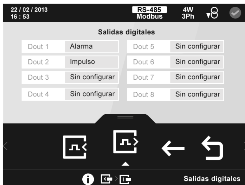
Figura 229: Pantalla de información de las salidas digitales (Módulo Entradas/Salidas digitales de Transistor)
