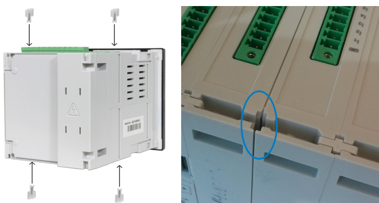
Figura 329: Introducir los clips de sujeción en las ranuras correspondientes.
