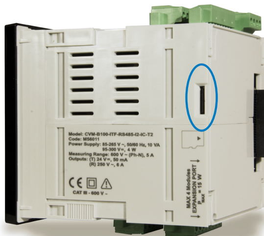
Figura 404: Posición de la ranura con la microSD.
