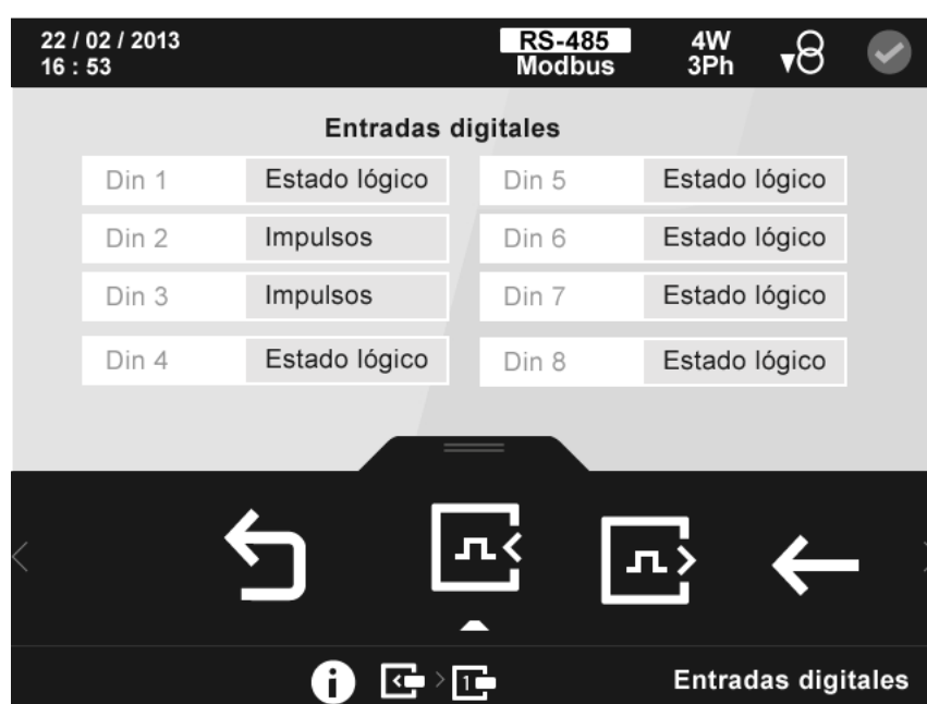
Figura 227: Pantalla de información de las entradas digitales (Módulo Entradas/Salidas digitales de Transistor).
