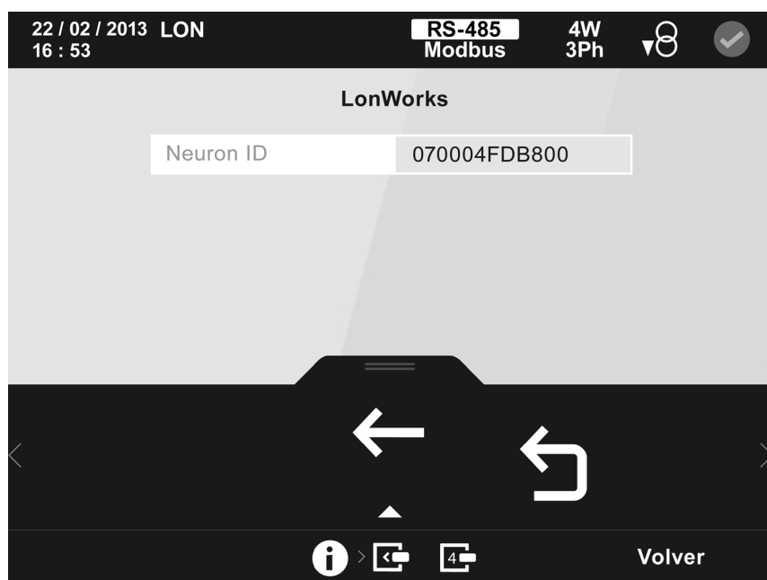
Figura 236: Pantalla de información del módulo LonWorks.
