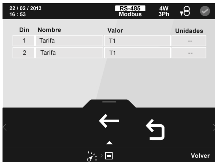
Figura 164: Pantalla de visualización de las entradas digitales integradas en el equipo.
