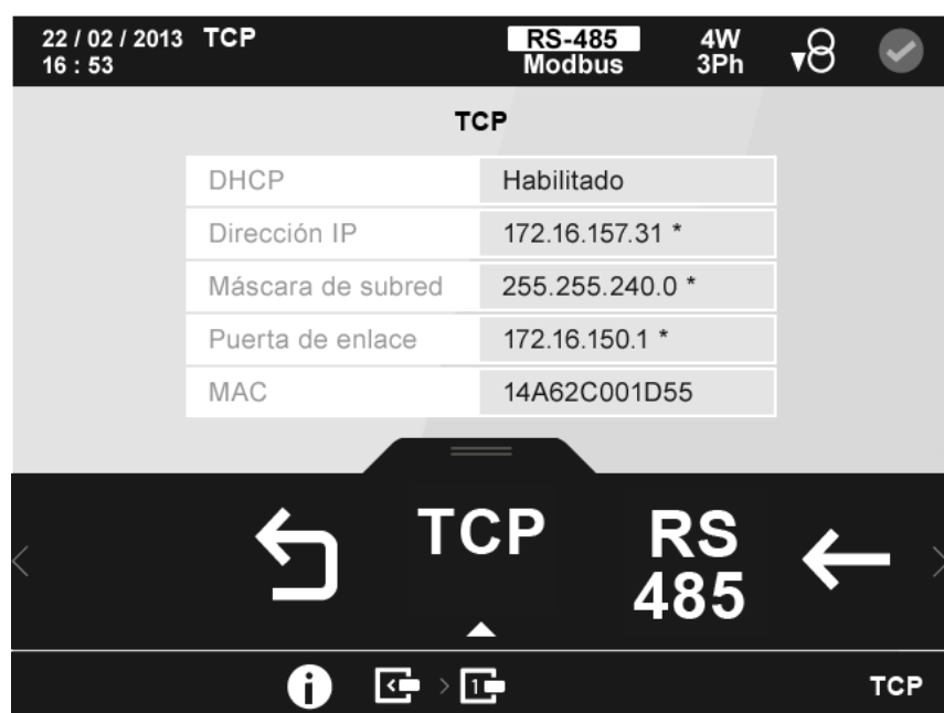
Figura 233: Pantalla de información del módulo Modbus TCP (Bridge) (Comunicación TCP).
