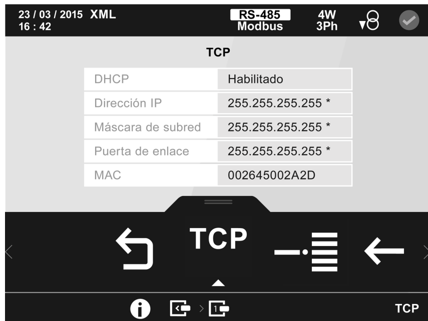
Figura 224: Pantalla de información del módulo Datalogger (TCP)
