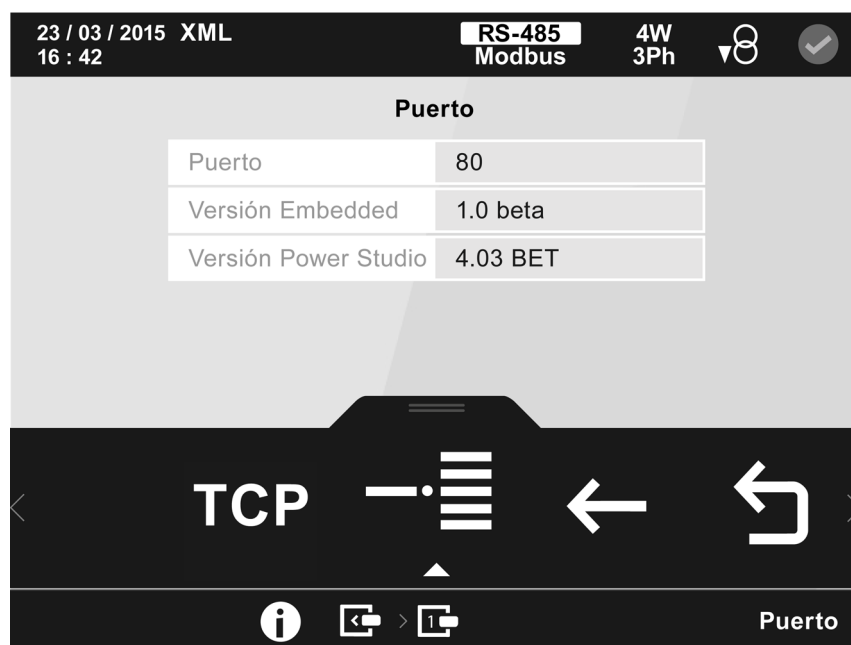
Figura 226: Pantalla de información del módulo Datalogger (Puerto)
