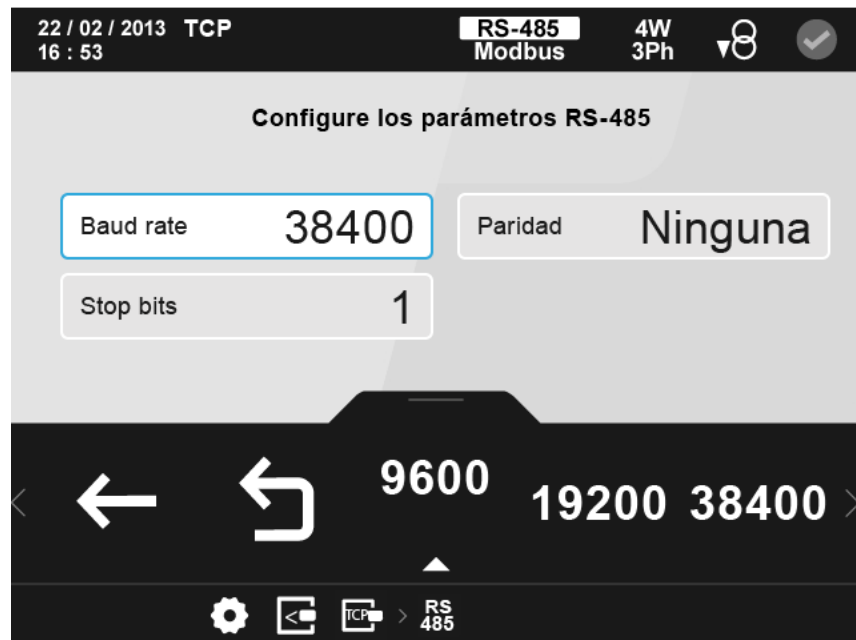
Figura 375: Pantalla de configuración del módulo Modbus TCP (Bridge) ( Pasarela RS-485)
