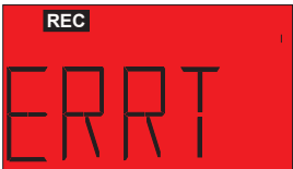
Figura 1:Error en la conexión del transformador diferencial.
