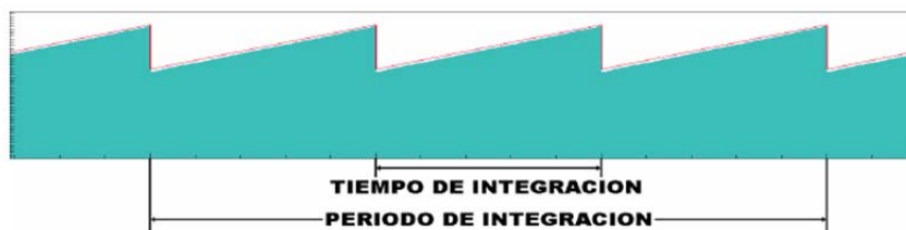
Fig. 8-11 . – Ventana de integración bloques deslizantes
