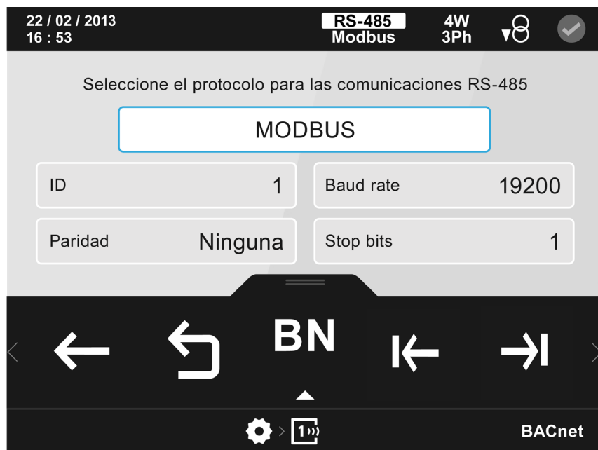
Figura 245: Pantalla de configuración de las comunicaciones integradas ( protocolo Modbus).
