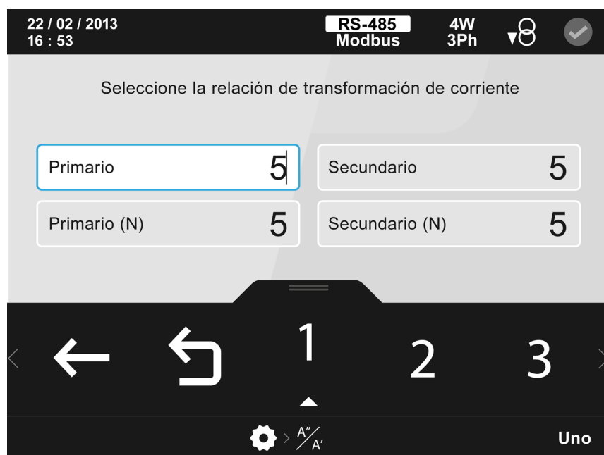
Figura 212: Pantalla de configuración de la relación de los transformadores de corriente.
