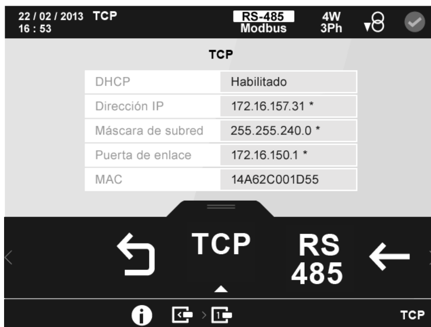
Figura 179: Pantalla de información del módulo Modbus TCP (Bridge) (Comunicación TCP).
