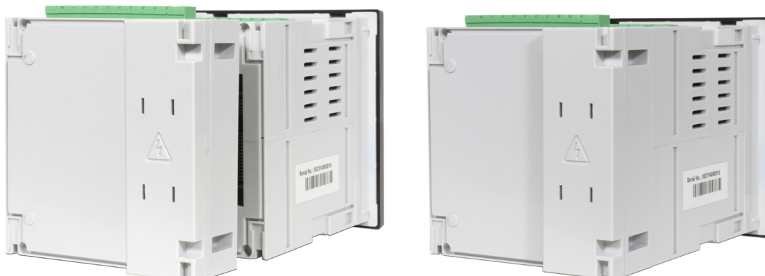
Figura 259: Conectar el módulo de expansión.
