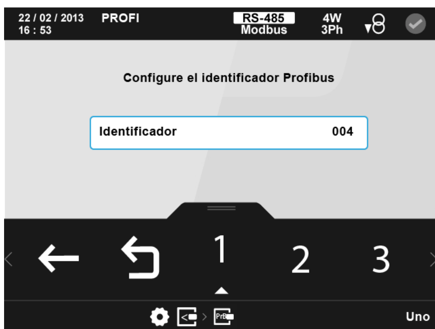
Figura 318: Pantalla principal de configuración del módulo Profibus
