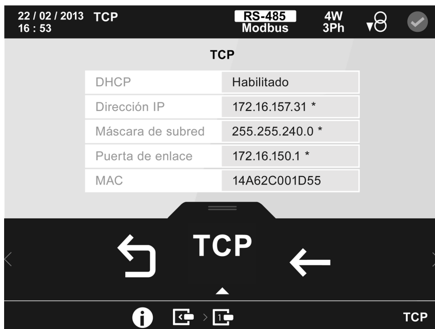
Figura 191: Pantalla de información del módulo Modbus TCP (Switch) (Comunicación TCP).
