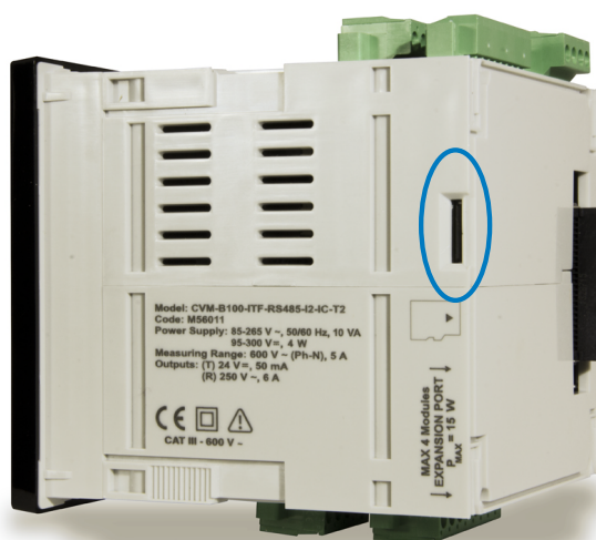
Figura 347: Posición de la ranura con la microSD.
